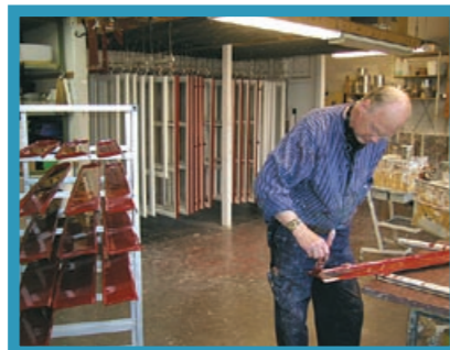
Målning av fönster och fönsterbleck Ystad, Sverige
